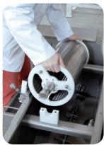
Exclusivo sistema de agitación de la salmuera mediante hélice, que mantiene la suspensión de los sólidos.
